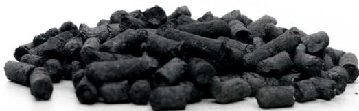
Endprodukt TCR-Biokohle nach der Pyrolyse.
